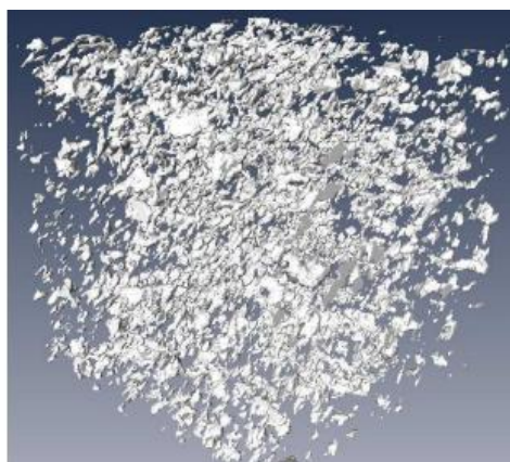
Figure 2-31 : Images issues de microtomographie de la porosité 3D d'un volume de 70 \times 70 \times 70 \mu\text{m}^3 d'un revêtement projeté plasma [Amsellem, 2008]
