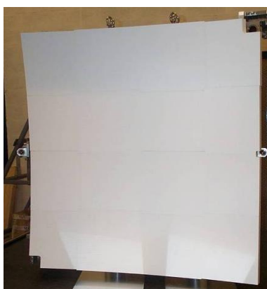
Figure 1-6 : Photo spectre de réflectivité sur la gamme 300-800nm du panneau diffusant en Spectralon utilisé au sein de la LIL
