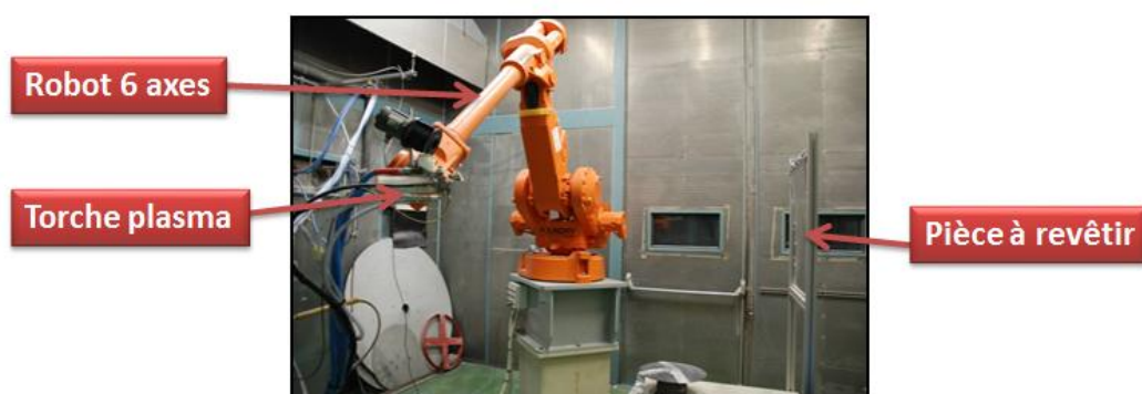
Figure 4-5 : Vue d'ensemble de l'enceinte de projection de la MAP 12
