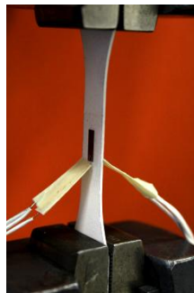
Figure B-1: Dispositif expérimental d'essai de traction sur une éprouvette d'alumine
