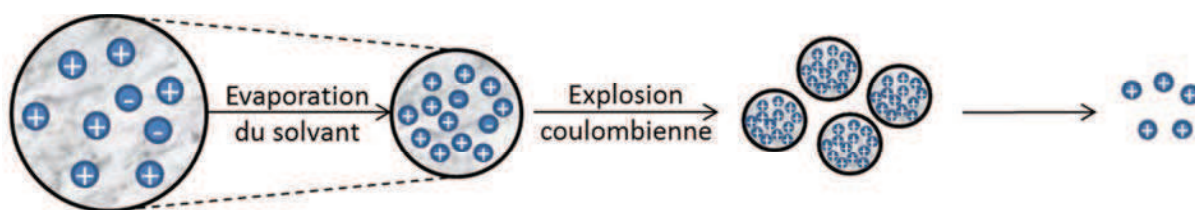
Figure 22 : Production d'ions en phase gazeuse suite à la répétition des deux premières étapes.
