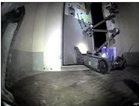
(c) Robot Packbot explorant la centrale nucléaire de Fukushima en 2011 après la fusion du cœur d'un réacteur [Tokyo Electric Power Co.]
