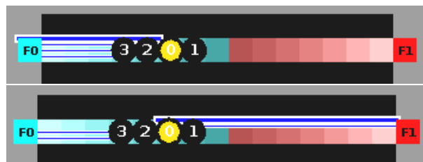
FIGURE 4.3 – En haut : MinDist : tous les robots sont assignés à la même frontière ; en bas : avec l'affectation souhaitée : les robots sont également répartis entre les deux frontières
