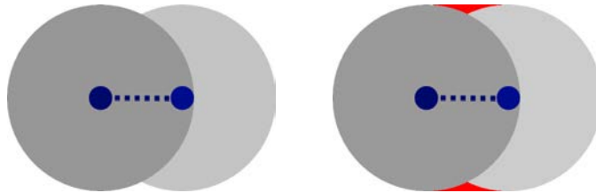
FIGURE 5.7 – Zone explorée quand le robot effectue une observation lorsqu'il arrive sur sa cible (à gauche) et quand sa fréquence d'observation est élevée (à droite). Les disques gris illustrent la zone perçue par le robot bleu. Le rouge illustre la différence entre les deux fréquences d'observation.
