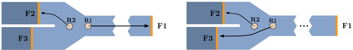
FIGURE 4.4 – Affectation souhaitée (à gauche) et affectation de l'algorithme Glouton (à droite).
