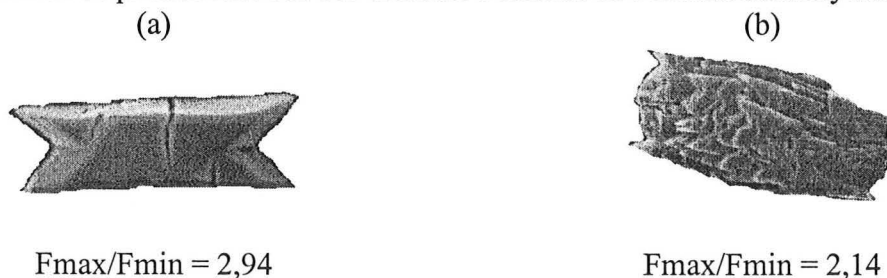
Figure II-1 : Quantification de la croissance directionnelle de deux monocristaux d'oxalate de calcium monohydraté vus sous la même face cristalline.
