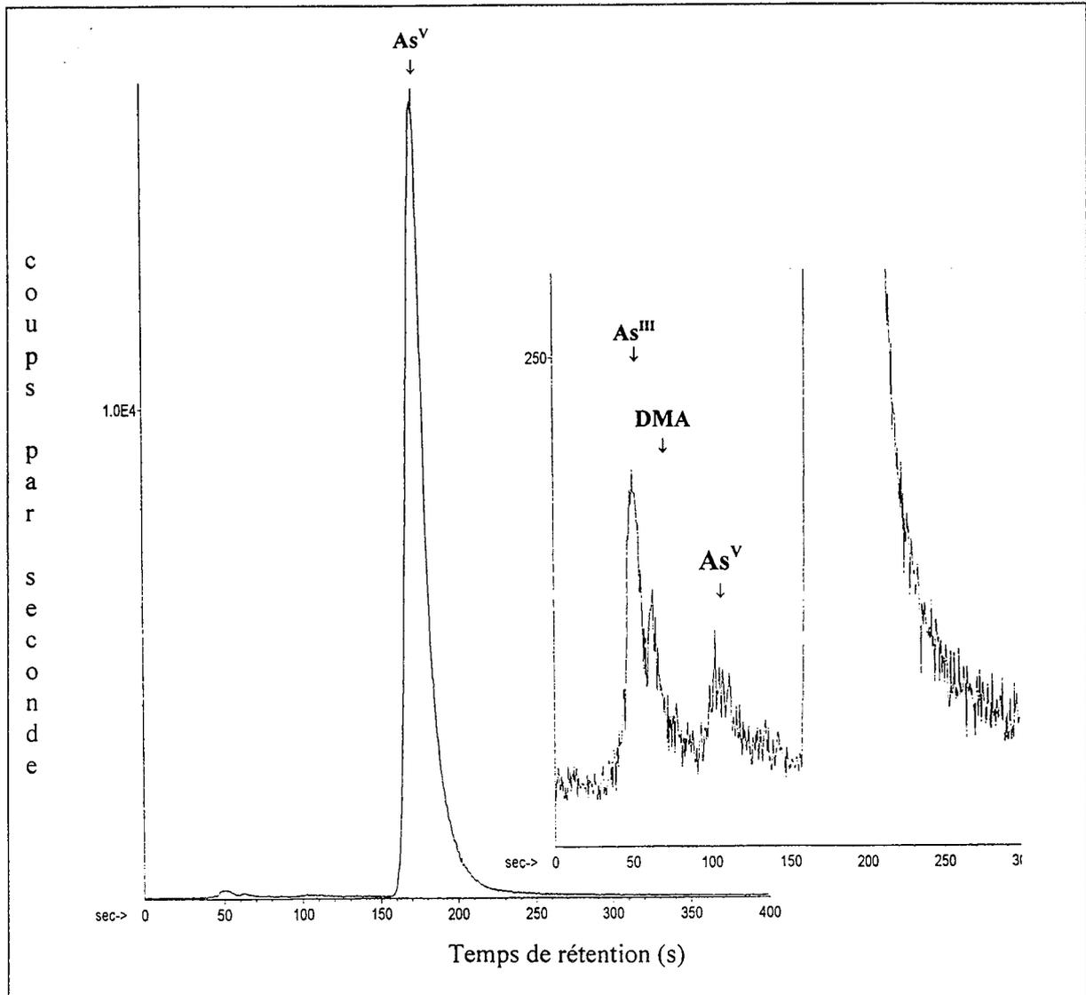
Figure 5.7 : Chromatogramme de la solution du sol du lysimètre 9 (GAB), quatre espèces d'As ont été détectées : arsénite ( $\text{As}^{\text{III}}$ ), arséniate ( $\text{As}^{\text{V}}$ ), monométhyl arséniate (MMA) et de diméthyl arséniate (DMA).
