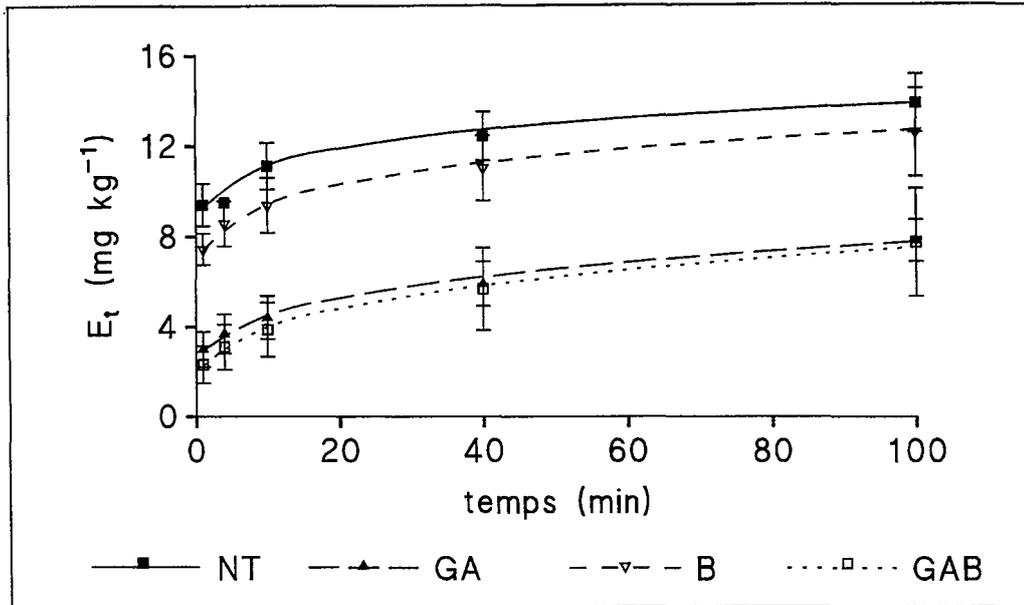
Figure 6.4 : Evolution de la quantité d'ions arséniate isotopiquement échangeable (moyenne de deux répétitions) en fonction du temps dans le sol non traité (NT) et les sols traités avec la grenaille d'acier (GA), la béringite (B) et leur combinaison (GAB). Points expérimentaux (symboles) et description par l'équation 6.4 (lignes).
