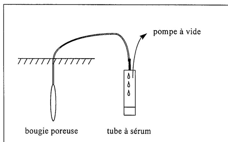
Figure 5.2 : Dispositif pour le prélèvement de la solution du sol
