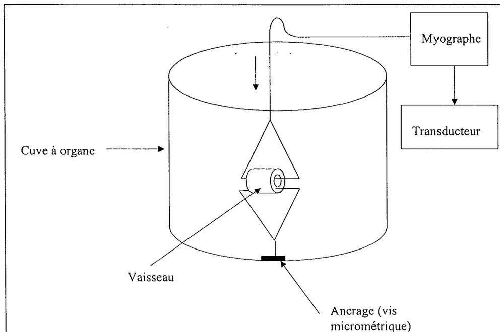
**Figure 30.** Schéma du montage d'un vaisseau isolé immergé.
