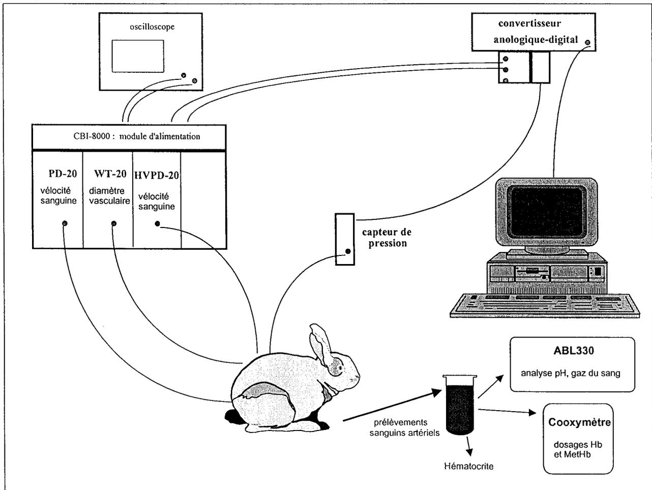
Figure 44. Le dispositif expérimental et les différents paramètres mesurés.
