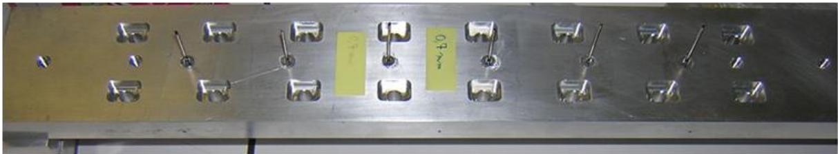
Figure III.4 : Plaque avec ses prises de pression
