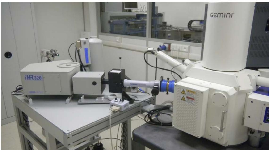
FIGURE 2.8 – Microscope électronique à balayage ZEISS Supra-TM 55 VP avec colonne GEMINI couplé au détecteur de cathodoluminescence.
