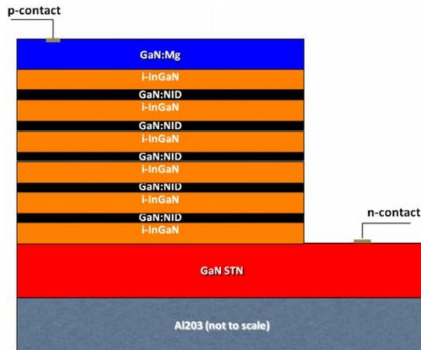
FIGURE 4.18 – Schéma de la structures pin "multicouche".
