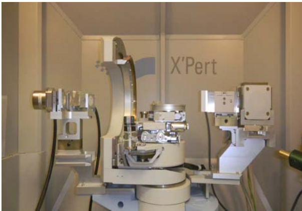
FIGURE E.2 – Diffractomètre à rayon X à haute résolution Philips X'pert
