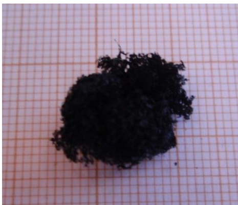
Figure 69 – Matériau final obtenu après le procédé de mise en forme des CNTs.
