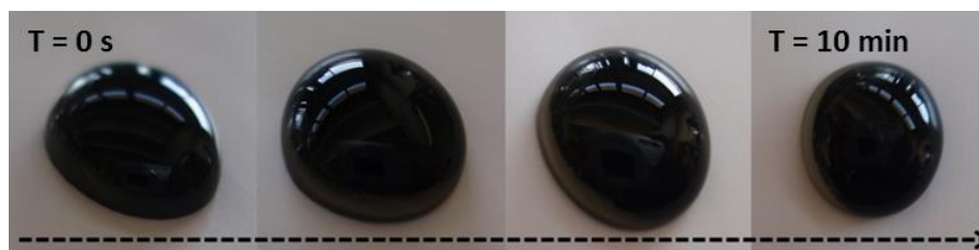
Figure 68 - Gouttes de solutions de SWCNTs sur une membrane hydrophobe. L'assemblage des SWCNTs à l'interface air/DMSO est observé au cours du temps.
