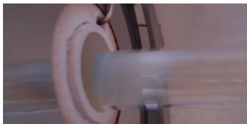
Figure 57 - Photographie du dépôt solide qui apparaît vers 820°C lors de la montée en température sous dichlore de l'échantillon de DWCNTs.
