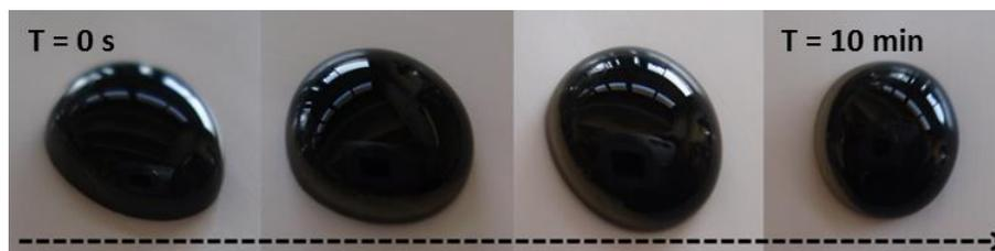
Figure 68 - Gouttes de solutions de SWCNTs sur une membrane hydrophobe. L'assemblage des SWCNTs à l'interface air/DMSO est observé au cours du temps.
