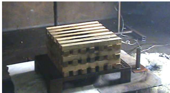
FIGURE 3.21 – Bûcher avant le début d'un essai
