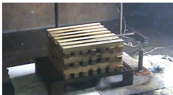
FIGURE 3.21 – Bûcher avant le début d'un essai
