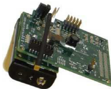
FIGURE 4.3: Une caméra Cyclops attachée à un mote Mica2
