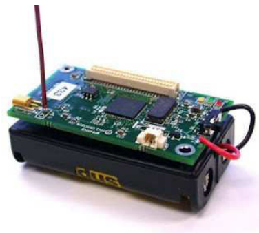
FIGURE 4.2: Un nœud capteur Mica2
