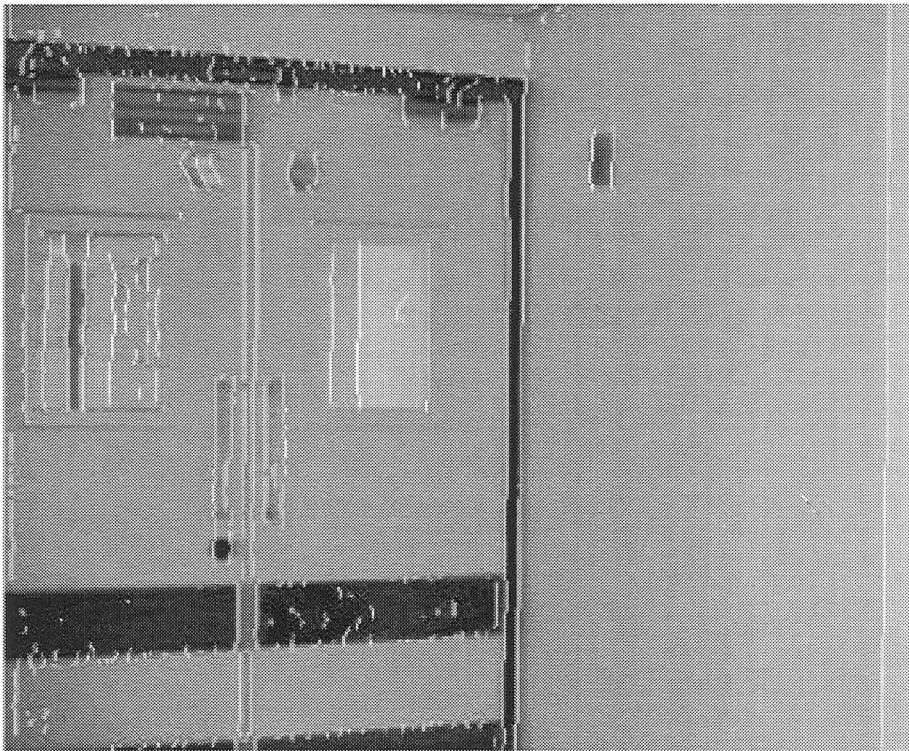
Figure 3.32 : Maxima locaux seuillés par s_{bas} .
