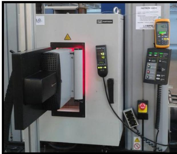
*Fig.V.4 L'enceinte thermique munie de l'extensomètre vidéo.*
