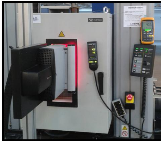
Fig.V.4 L'enceinte thermique munie de l'extensomètre vidéo.
