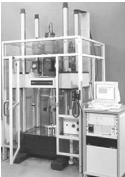
Fig.V.2 Machine rapide servo-hydraulique (à gauche) et la cellule de chargement dynamique (à droite).
