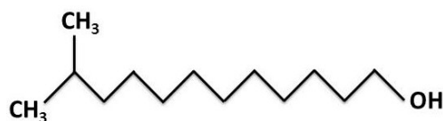
Figure 2-28 - Formule semi-développée du PX4826 ou Isotridécanol
