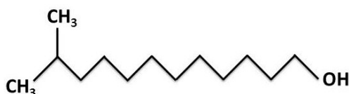
Figure 2-28 - Formule semi-développée du PX4826 ou Isotridécanol
