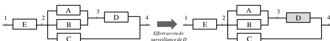
Figure 4.18. Scénario d'efforts accrus sur le composant D dans la configuration 2
