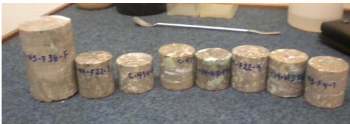
Figure 21- Les échantillons du bassin de Cardenas utilisés pour l'étude de l'injection de mercure et la tomographie ; en vert la résine.
