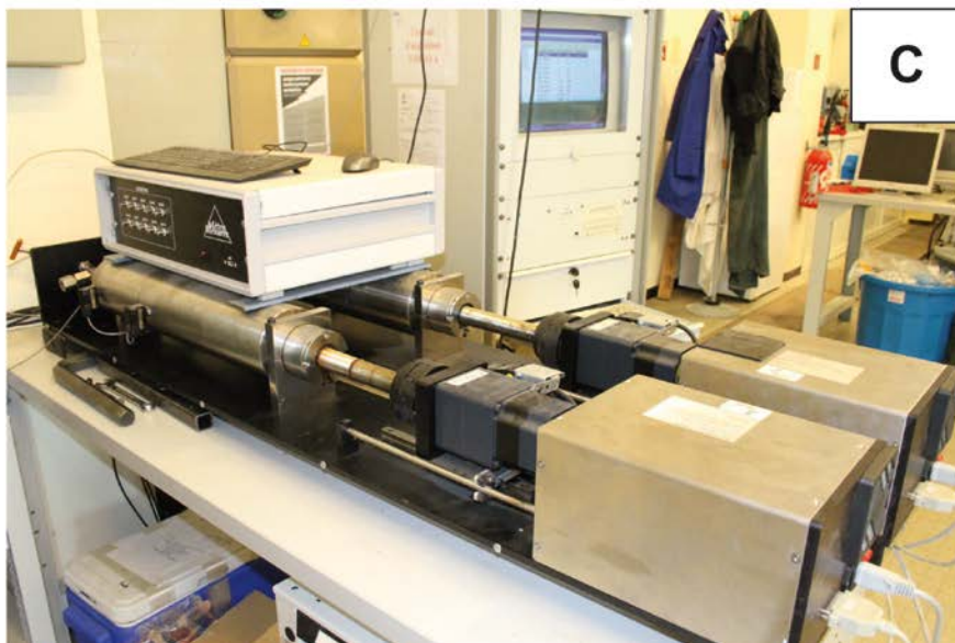
Figure 27. Photographies du dispositif de percolation sous contraintes. (A) Cellule triaxiale, (B) Système de circulation de fluides aqueux, (C) Générateurs de contrainte de confinement et de contrainte déviatorique.
