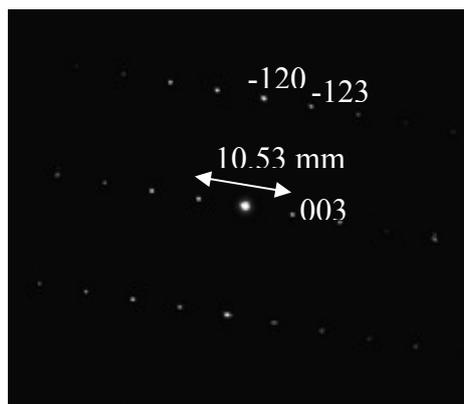
**Figure 106** Cliché de diffraction indexé d'un échantillon de calcite industrielle, AZ = [210].
