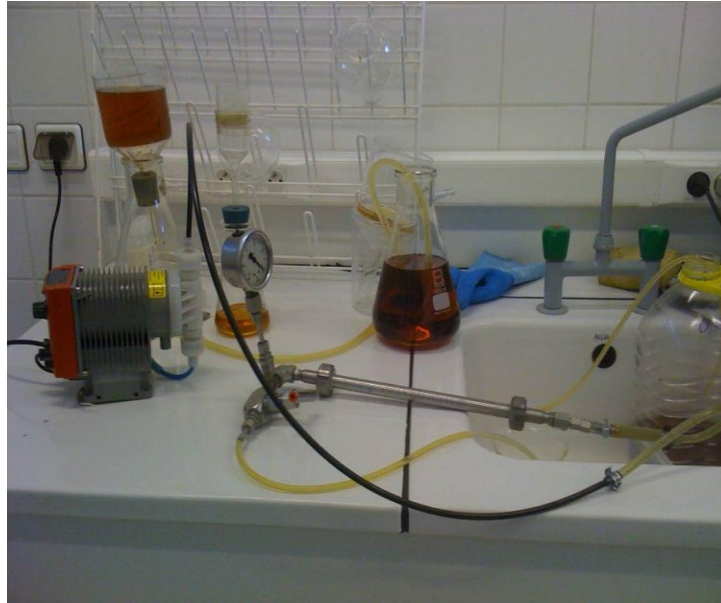
Photo 1: Dispositif de filtration tangentielle (100 ml)
