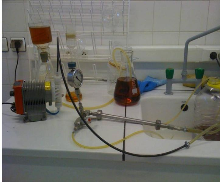
Photo 1: Dispositif de filtration tangentielle (100 ml)
