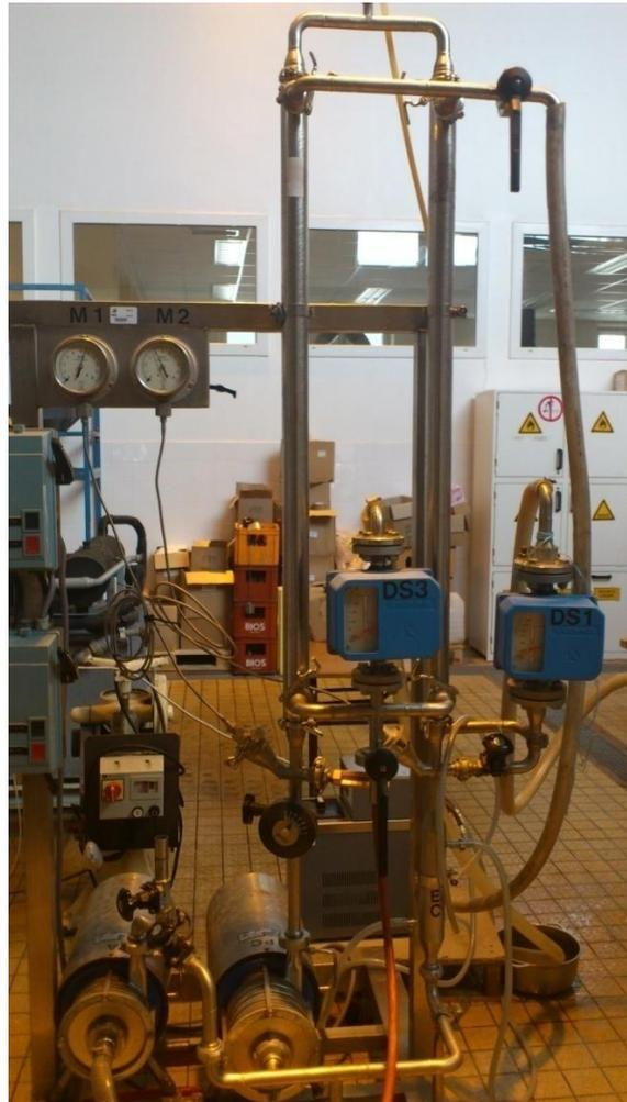
Photo 3: Pilote d'ultrafiltration tangentielle
