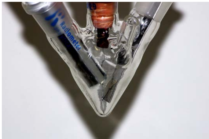
Photographie de la cellule d'électrodéposition utilisée au cours de la thèse
