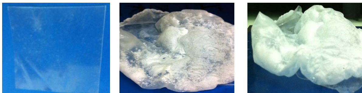
Figure B-19 Membrane élastomère en PDMS. Gauche : membrane native; Centre et droite: membrane après expérience d'absorption du CO 2 dans l'ammoniaque
