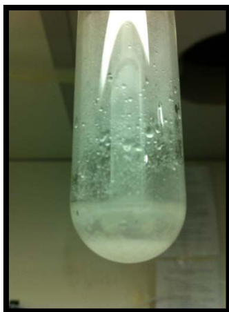
Figure C-9 Formation de sels d'ammonium côté gaz récupérés dans les pièges situés en aval du contacteur
