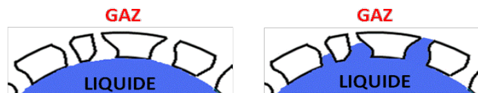
Figure A-12 Mouillage des membranes microporeuses
