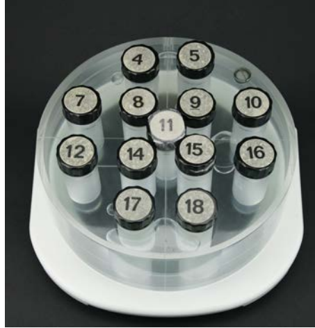
FIGURE 2.20 – Fantôme utilisé pour contrôler les capacités relaxométriques des appareils d'IRM. Le réceptacle cylindrique accueille 13 tubes remplis de gel dont les temps de relaxation sont mesurés.
