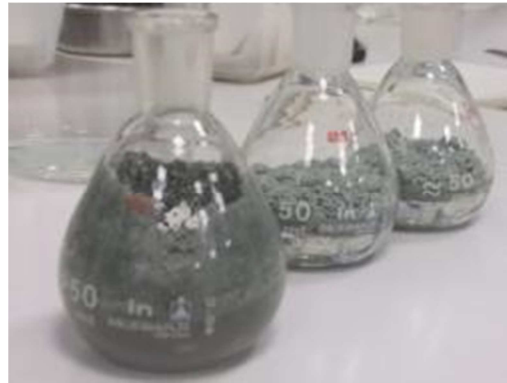
Figure III-6 : illustration de la mesure de la densité réelle des sous-produits papetier dans de l'eau dans des pycnomètres
