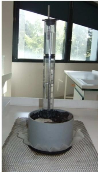
**Figure III-7** : illustration de la mesure de la conductivité hydraulique à saturation du compost à l'aide d'un infiltromètre à minidisque
