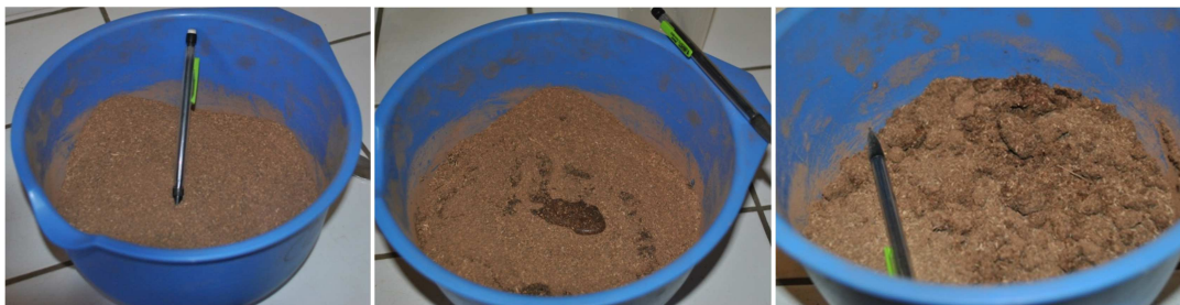
Figure IV-2: étapes de réalisation des mélanges, cas du mélange brique/déchets verts
