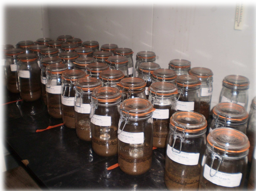
Figure IV-3 : photographie du dispositif d'expérience d'incubation en conditions contrôlées
