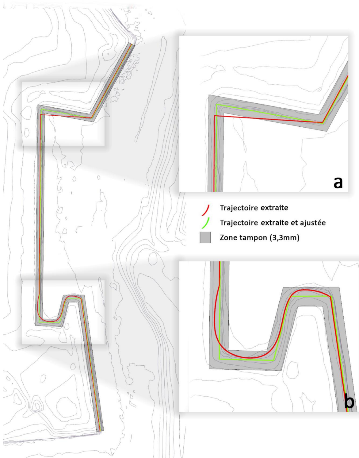
Figure 130. Trajectoire du front 2 de Marsal reconstruit après segmentation à une précision de 97,07% pour une zone tampon de 3,3 mm.
