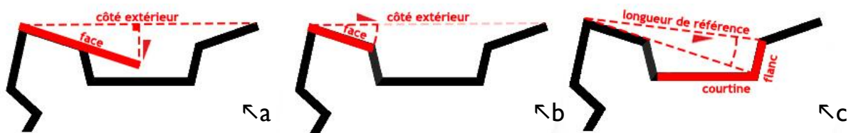
Figure 106. Le premier paramètre contrôle l'angle formé par les faces et le côté extérieur par l'intermédiaire d'une perpendiculaire dont on peut varier la longueur (a). Le second paramètre contrôle la longueur des faces en fonction de la longueur du côté extérieur (b). Le dernier paramètre contrôle la position du sommet formée par la courtine et les flancs (c) par rapport à la longueur du segment reliant le sommet du bastion opposé à l'angle de l'épaule.
