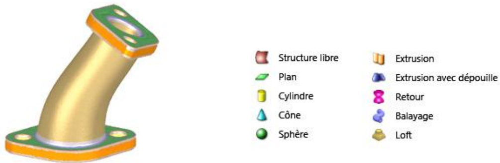
Figure 15. Segmentation avec le logiciel Geomagic Studio d'un collecteur d'admission numérisé. Le maillage a été automatiquement analysé et segmenté en fonction d'une typologie d'objets géométriques prédéfinis : plan, extrusion, etc. D'après : geomagic.com
