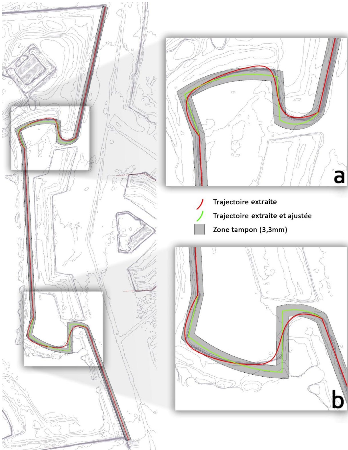
Figure 129. Trajectoire du front 1 de Strasbourg reconstruit après segmentation à une précision de 93,87% pour une zone tampon de 3,3 mm.
