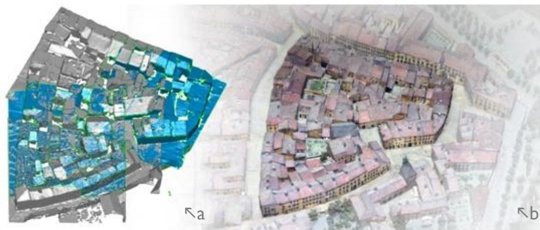
Figure 13. Une consolidation est nécessaire à la fusion en un seul maillage des cinq relevés effectués à une résolution de 0,5 mm de l'ilot 23 du plan-relief de Toul (b) alors qu'il ne couvre une surface que d'une vingtaine de centimètres carrés.
