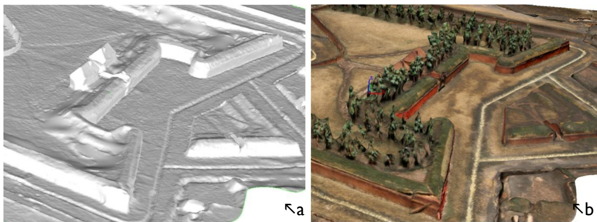
Figure 109. Le maillage utilisé pour l'opération de segmentation (a) doit être dépourvu de géométries aberrantes telles que les trous de petite taille ou les pics formés par des triangles qui peuvent se croiser comme c'est le cas de la végétation des plans-reliefs (b). De plus, la suppression de ces géométries oblige l'utilisateur à intervenir dans la phase de prétraitement des données relevées pour reconstruire les parties masquées par la végétation.
