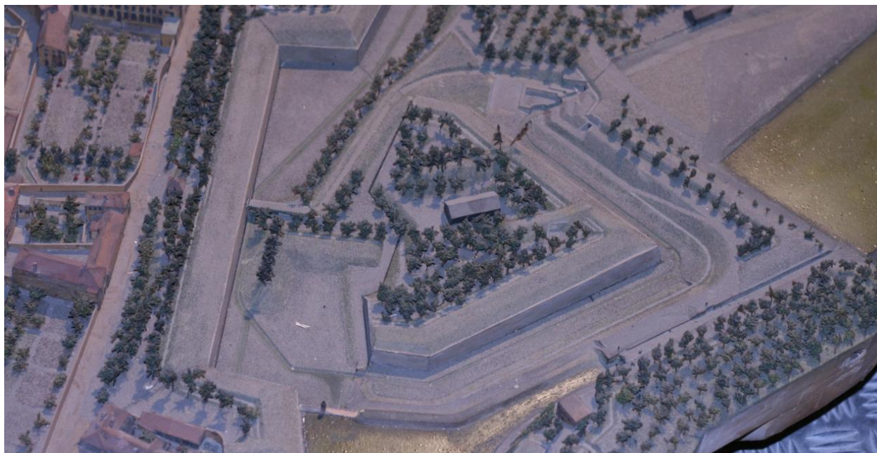
Figure 101. Une demi-lune à flanc sur le plan-relief de Toul.
