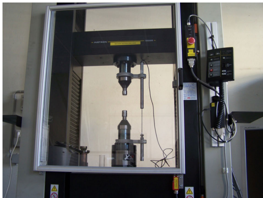
Figure 2 : Machine de compression Instron avec les poinçons de compression
