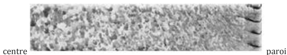
Figure 1- 29 : Evolution de la morphologie des grains du centre à la paroi du produit, pour une billette de 200mm de diamètre d'un alliage 7075 (E. D. Nadella R. 2008).
