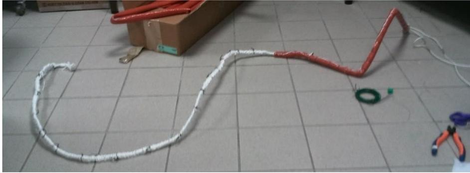
Tube en inox entourée de cordon chauffant puis de laine de verre permettant un chauffage homogène de la ligne chauffée qui est entourée de gaine permettant la protection et le contact à la chaleur.
