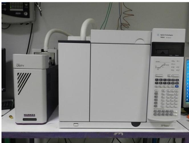
Thermodésorbeur Markes Unity2 couplé à un chromatographe en phase gazeuse (Agilent 7890) muni d'un détecteur à conductibilité thermique (TCD) et/ou d'un détecteur à ionisation de flamme (FID) permettant la quantification des produits de réaction d'oxydation ou de pyrolyse du DBF, piégés sur les cartouches d'adsorbant.
