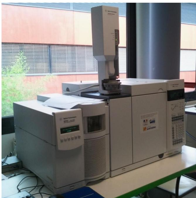
Couplage spectromètre de masse simple quadripôle (Agilent MSD 5975 EI) et chromatographie en phase gazeuse (Agilent 7890A) permettant l'identification des produits d'oxydation et de pyrolyse du DBF.
