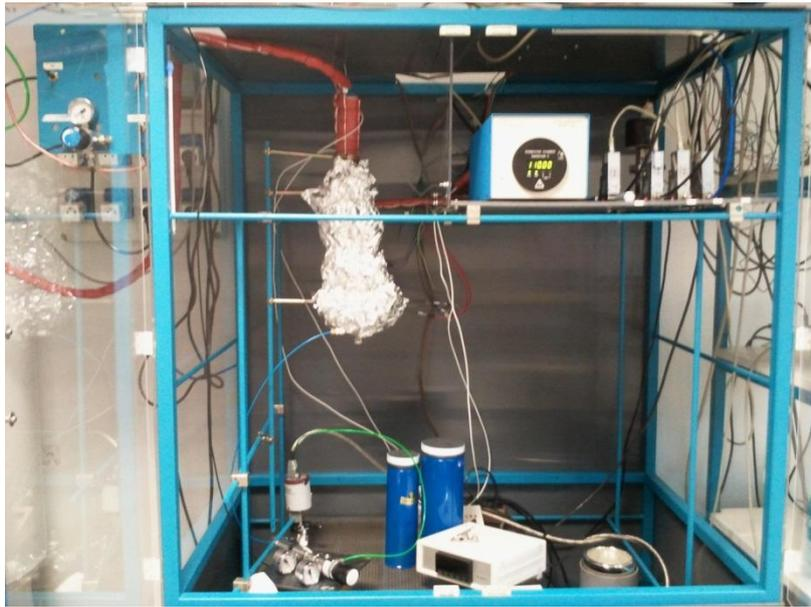
Connexion du réacteur à la ligne chauffée. La ligne chauffée est entièrement entourée par une gaine isolante permettant ainsi d'éviter tout contact et brûlures éventuelles. L'ensemble réacteur/préchauffage est calorifugé avec de la laine de quartz protégée par du papier d'aluminium.
