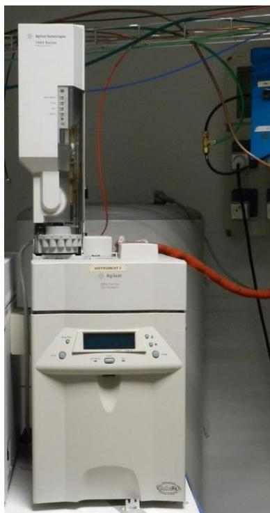
Chromatographe en phase gazeuse (CPG - Agilent HP 6850) muni d'un détecteur à ionisation de flamme (FID) qui nous permet de quantifier la teneur initiale en DBF.
