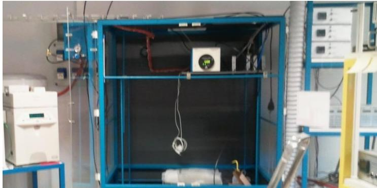
Montage de la ligne chauffée reliant le dynacalibrateur ou CPG - Agilent HP 6850
