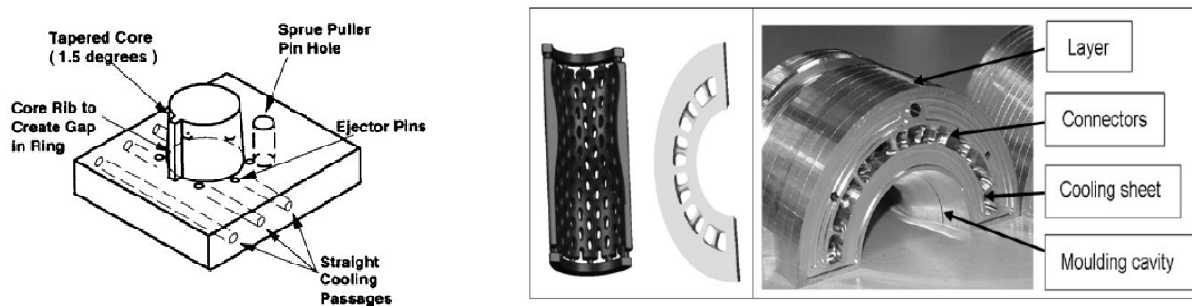
Figure.I.3. Différence entre outillages standards et outillages obtenus par Stratoconception [1-2].
