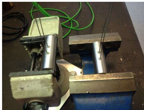
Figure.V.11. Montage des thermocouples sur les éprouvettes.
