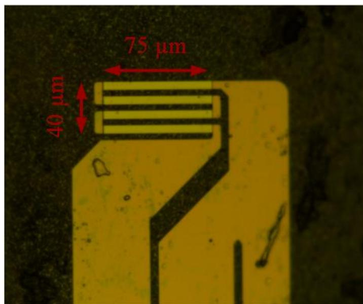
*Figure d. Zone active pour chaque élément de détection.*
