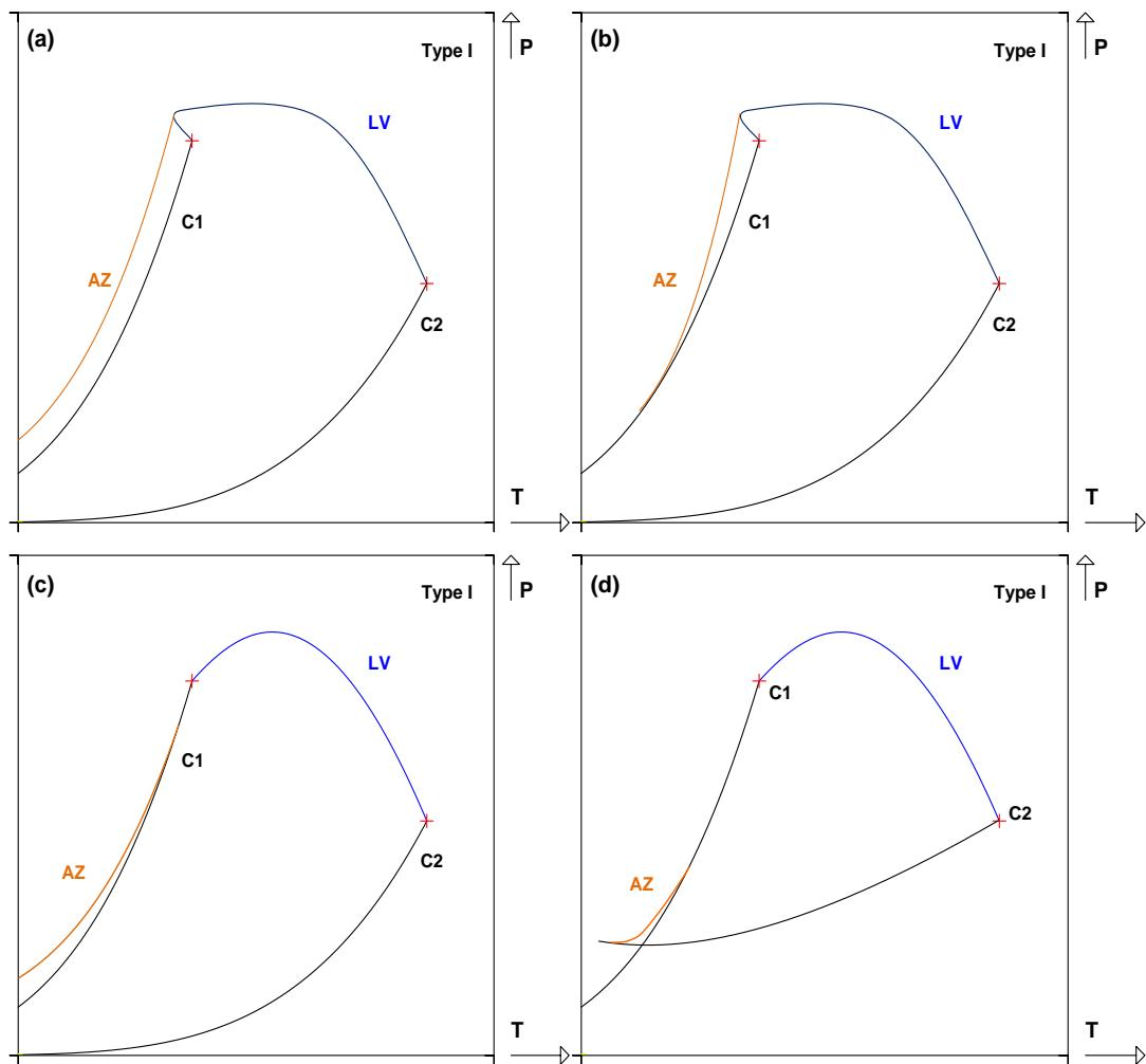
**Fig. 9** Différentes configurations de diagramme de type I possédant un azéotrope positif.
