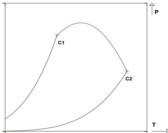
**Fig. 7 Lieu des points critiques d'un système binaire dans le plan  $P$ - $T$  ; (ligne bleu) : lieu des points critiques, (ligne noire) : courbe de vaporisation et (+) : point critique des corps purs.**
