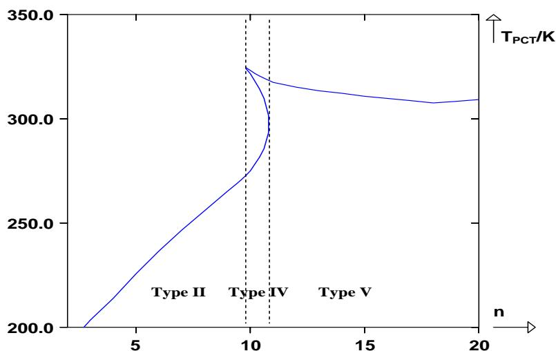
**Fig. 16 Evolution des températures critiques terminales ( $T_{PCT}$ ) en fonction de nombre d'atomes de carbone ( $n$ ) dans les mélanges binaires  $\text{CO}_2 + n\text{-alcan}$  (Prédiction par le modèle PPR78).**
