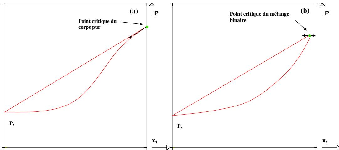
**Fig. 6 Apparition du point critique dans un diagramme de phases binaire tel que  $T_{c1} = \text{Min}\{T_{c1}, T_{c2}\}$ ; (a) :  $T = T_{c1}$  et (b) :  $T = T_{c1} + \epsilon$**
