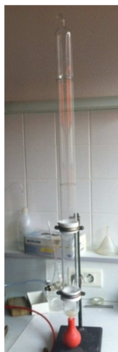
Figure 2-18 : Photo d'une colonne à bulles.
