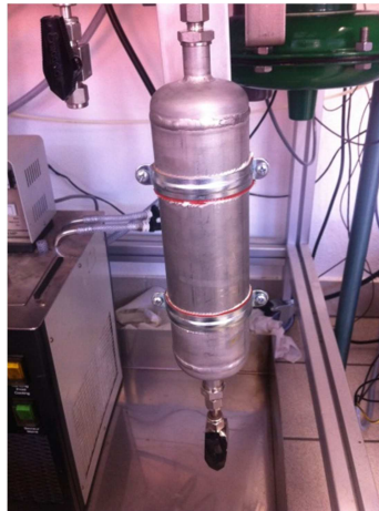
Figure 5-7 : Photo d'un réservoir liquide permettant de stocker l'eau au fur et à mesure d'une expérience.
