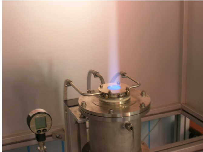
Figure 3-19 : Flamme de méthane à pression atmosphérique et 298 K, enrichie avec 67% d'hydrogène.
