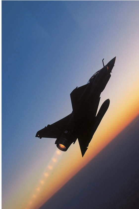
Figure I-2 : Photo d'un Mirage 2000D équipé d'un turboréacteur Snecma M53.
