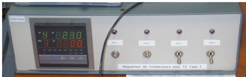
Figure 2-21 : Régulateur permettant de vérifier la température au sein de la chambre de mélange des gaz.
