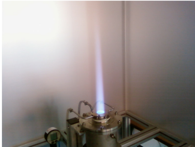
Figure 3-22 : Flamme de méthane à pression atmosphérique et 298 K, enrichie en oxygène pour D = 0,35 .
