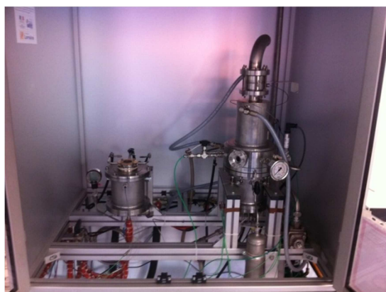
Figure C-1 : Photo des deux dispositifs expérimentaux (à pression atmosphérique et à haute pression)
