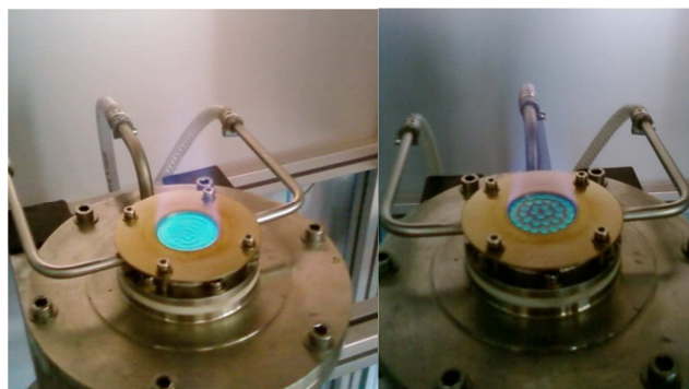
Figure 4-12 : Photos des instabilités pouvant apparaître lors de mesures de vitesses de flammes de composés liquides pour des richesses supérieures à 1,6. Cas de l'éthanol.
