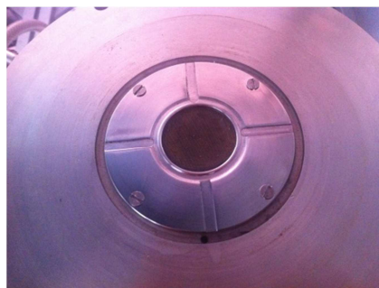
Figure 5-8 : Photo de la rondelle équipée de canaux pour l'évacuation de l'eau produite.
