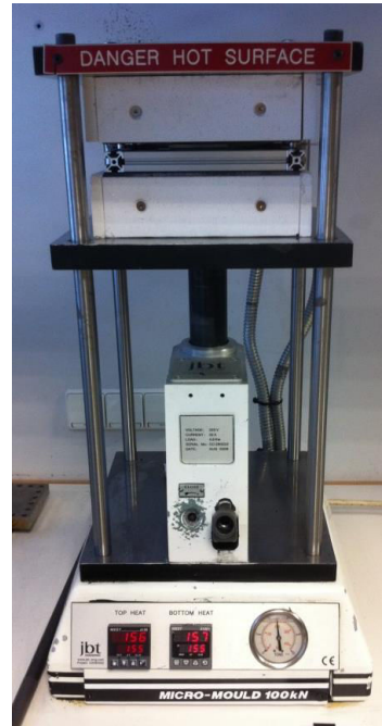
Figure 2-13 : Photographies de la presse chauffante utilisée pour la vulcanisation du caoutchouc.
