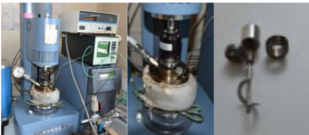
Figure 31. Rhéomètre AR2000 (TA instruments) équipé d'une cellule de pression
