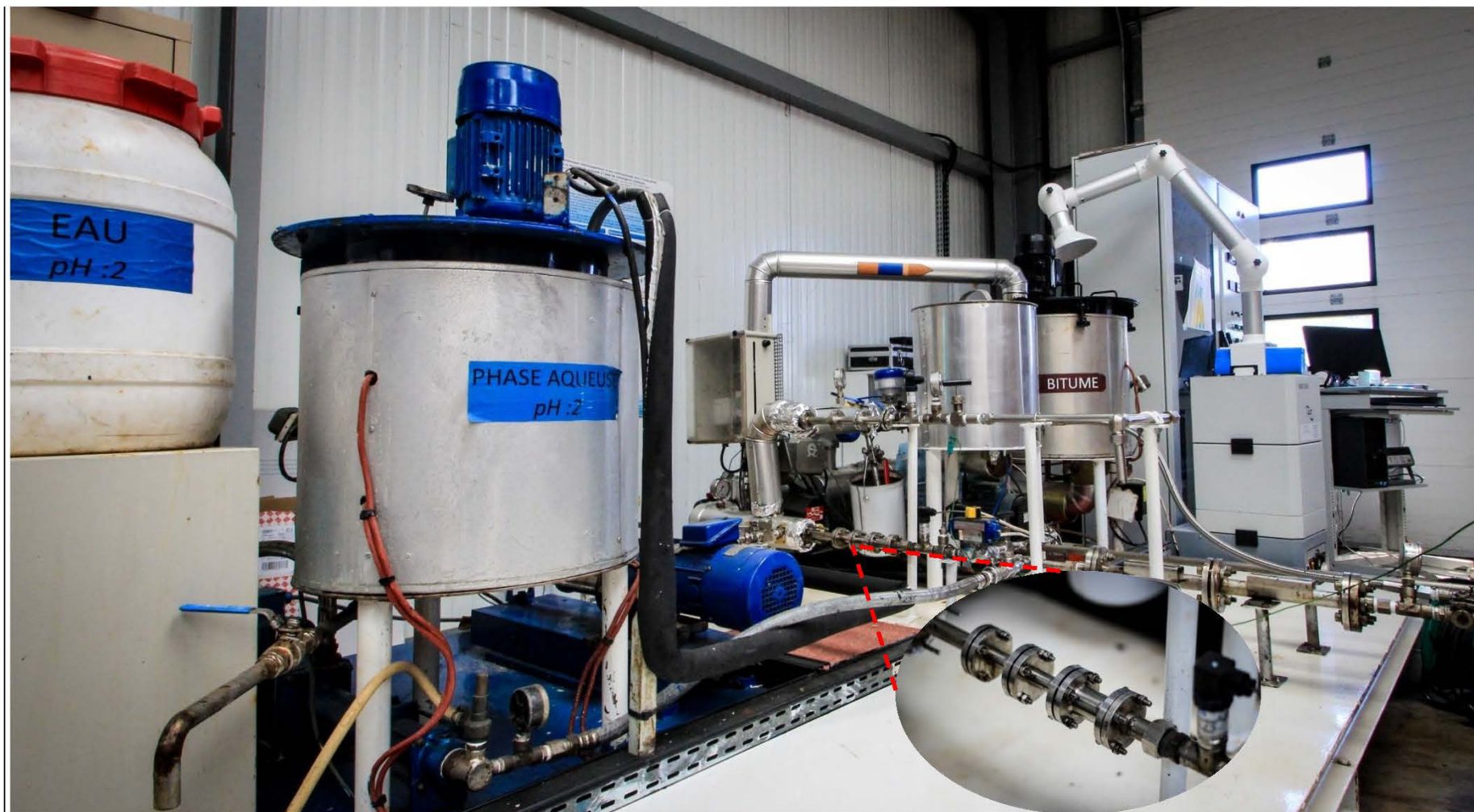
Figure 44. Pilote pour la fabrication d'émulsions de bitume à l'aide de mélangeurs statiques (Photo : V. Darrailan. Centre de Recherche d'Eurovia Mérignac, 2014)
