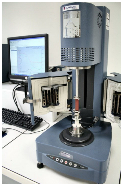
Figure 36. Rhéomètre AR2000 (TA instruments)
