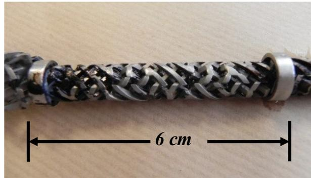
Figure 70. Etat du mélangeur DN10 N°2, après l'émulsification
