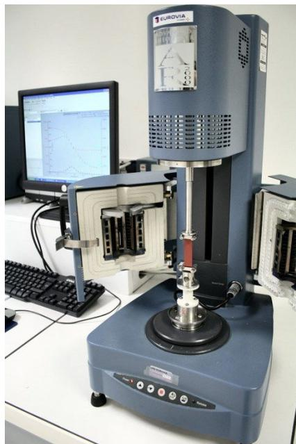
**Figure 36. Rhéomètre AR2000 (TA instruments)**
