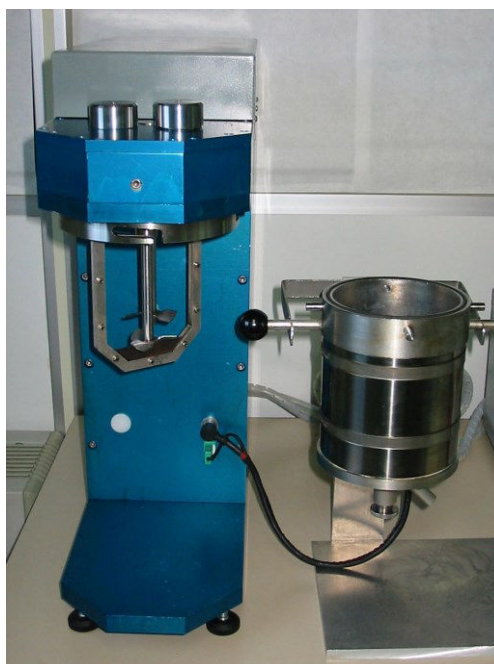
Figure 30. Mélangeur discontinu pour la fabrication d'émulsions concentrées de bitume
