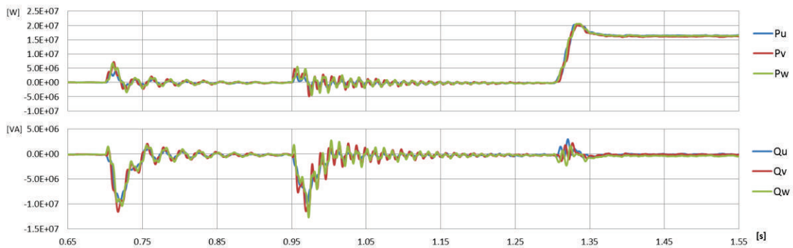
Figure 51 : Puissances actives (haut) et réactives (bas) mesurées au réseau 33kV pendant les enclenchements des filtres réseau et du four
