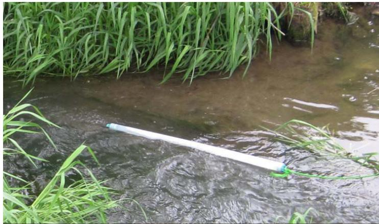
*Figure II.8 : bailer lancé pour prélever un échantillon.*
