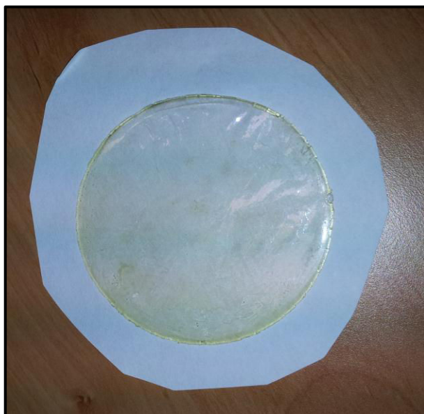
Figure A. 13 : Membrane dense en polyuréthane
