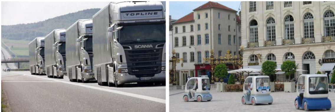
FIGURE 1.1 – à droite : Platooning de quatre camions, à gauche platooning de trois véhicules électriques.
