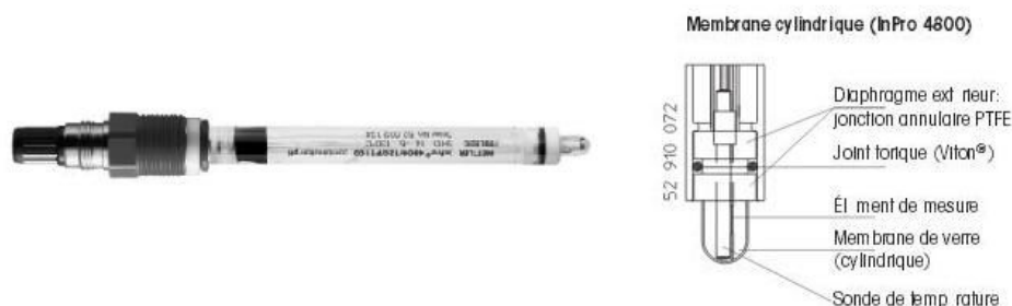
FIGURE 2.17 – Schéma de la sonde pH InPro 4800 Mettler Toledo [40]
