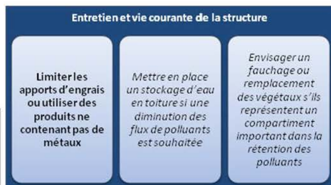
Figure 87- Synthèse des préconisations techniques pour une diminution des flux d'ETM en sortie de toiture végétalisée
