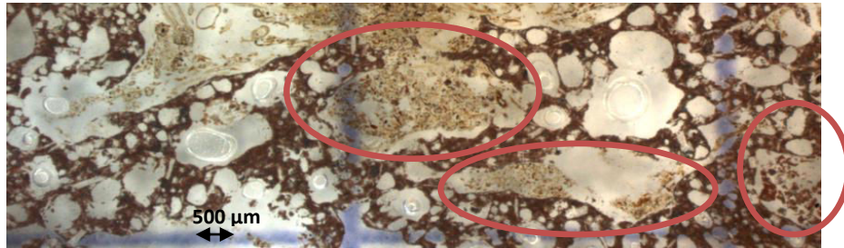
Figure 62 - Colmatage progressif de vides intra-particulaires (vésicules) par des particules fines et notamment de la matière organique (point de prélèvement 3)
