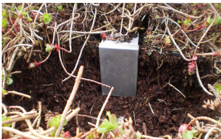
Figure 14 - Prélèvement du substrat extensif dans une boîte de Kubiena
