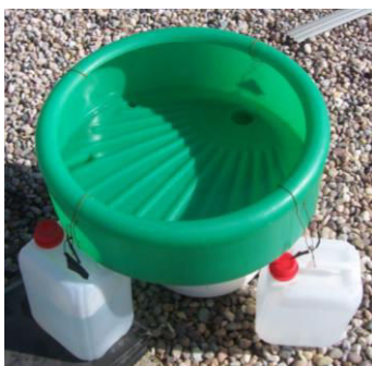
Figure 15 - Entonnoir permettant la récupération des dépôts atmosphériques.
