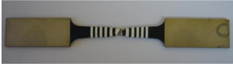
*Figure 2-4. Epreuve de traction de titane commercialement pur après la rupture. On note qu'il n'y a pas de rotation des bandes peintes.*
